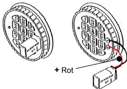
Wird der Batterietausch vergessen und die Spannung reicht nicht mehr aus, um die Sperrfunktion des Schlosses bis der aufzuheben, wird so lange eine neue 9V-ALKALINE Batterie auf die Kontakte der Tastatur gedrückt, Code eingegeben und die Tastatur gedreht wurde.
